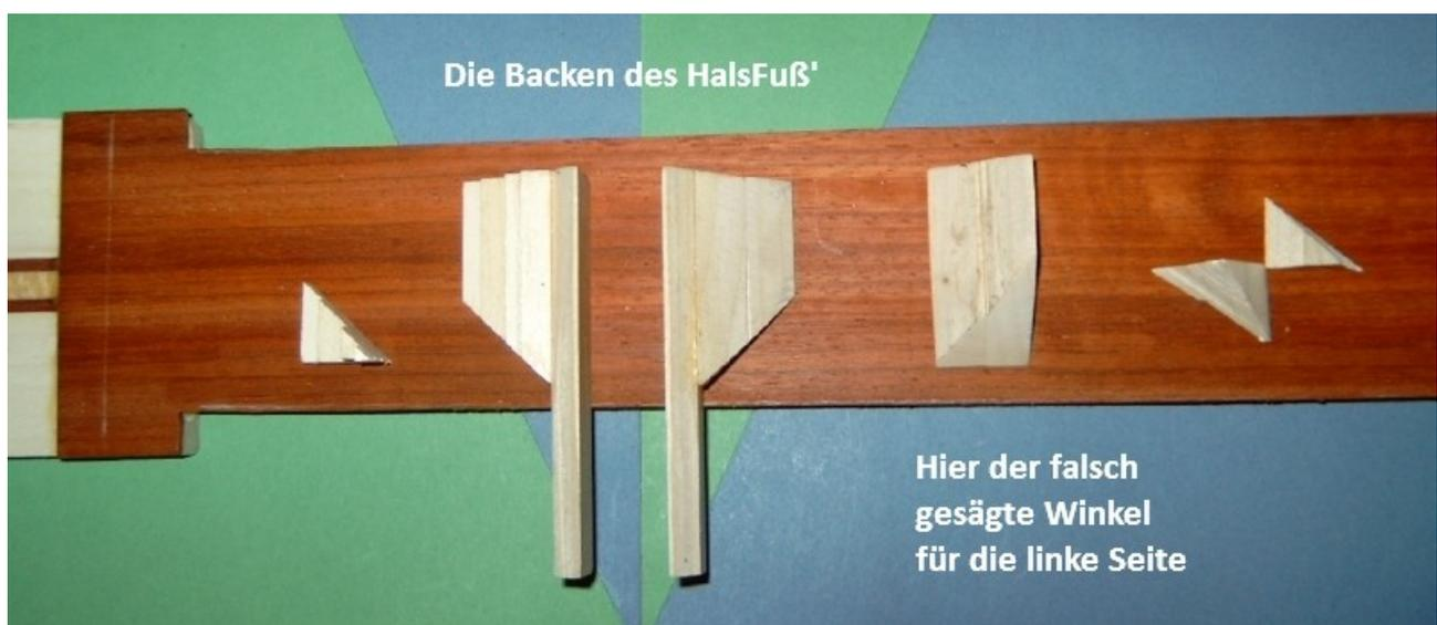
Auf dem Hals mit der ersten aufgeleiteten horizontalen Zwischenlage liegend (Padouk) die neuen Bauteile des Halsfuß': In der Mitte die beiden Backen, von der noch die linke sauber gefeilt und geschliffen werden muss. Rechts daneben der Fauxpas des Tages.
