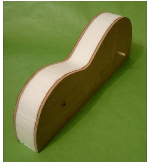
Zusammen mit den an beiden Seiten abgebrachten Backen von jeweils 7 mm hat die Negativform eine Gesamtbreite von 82 mm und die Positivform kommt auf eine Gesamtbreite von 62 mm.
