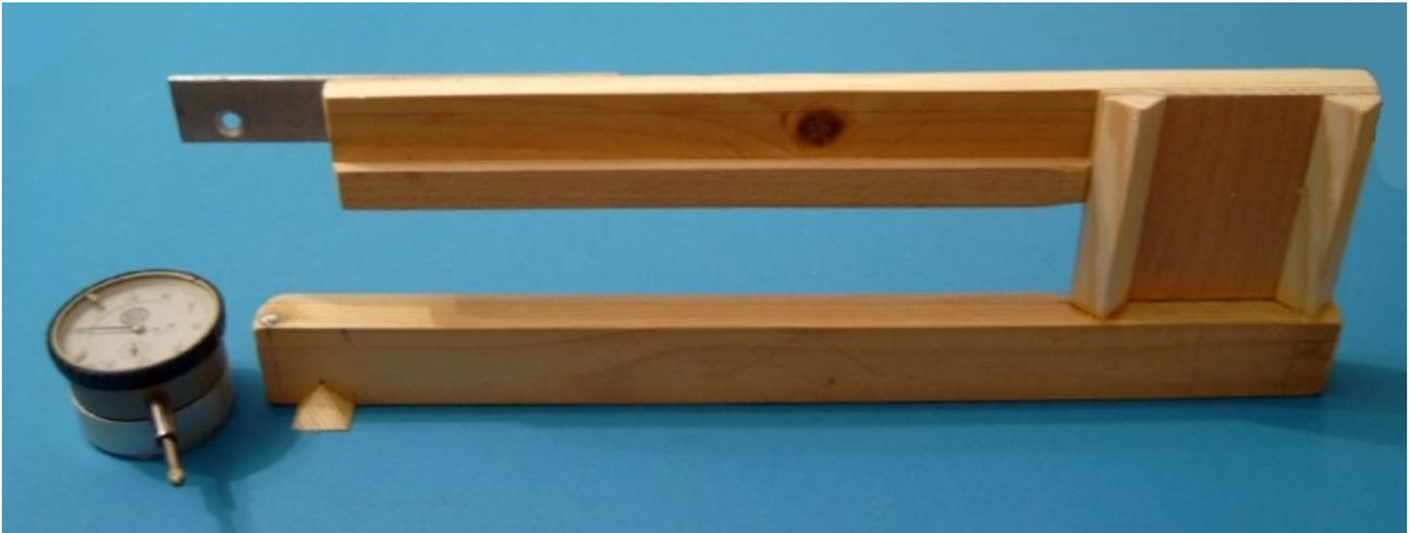
Hier das gesamte Messgerät, mit und ohne magnetisch angeklickter Messuhr.
