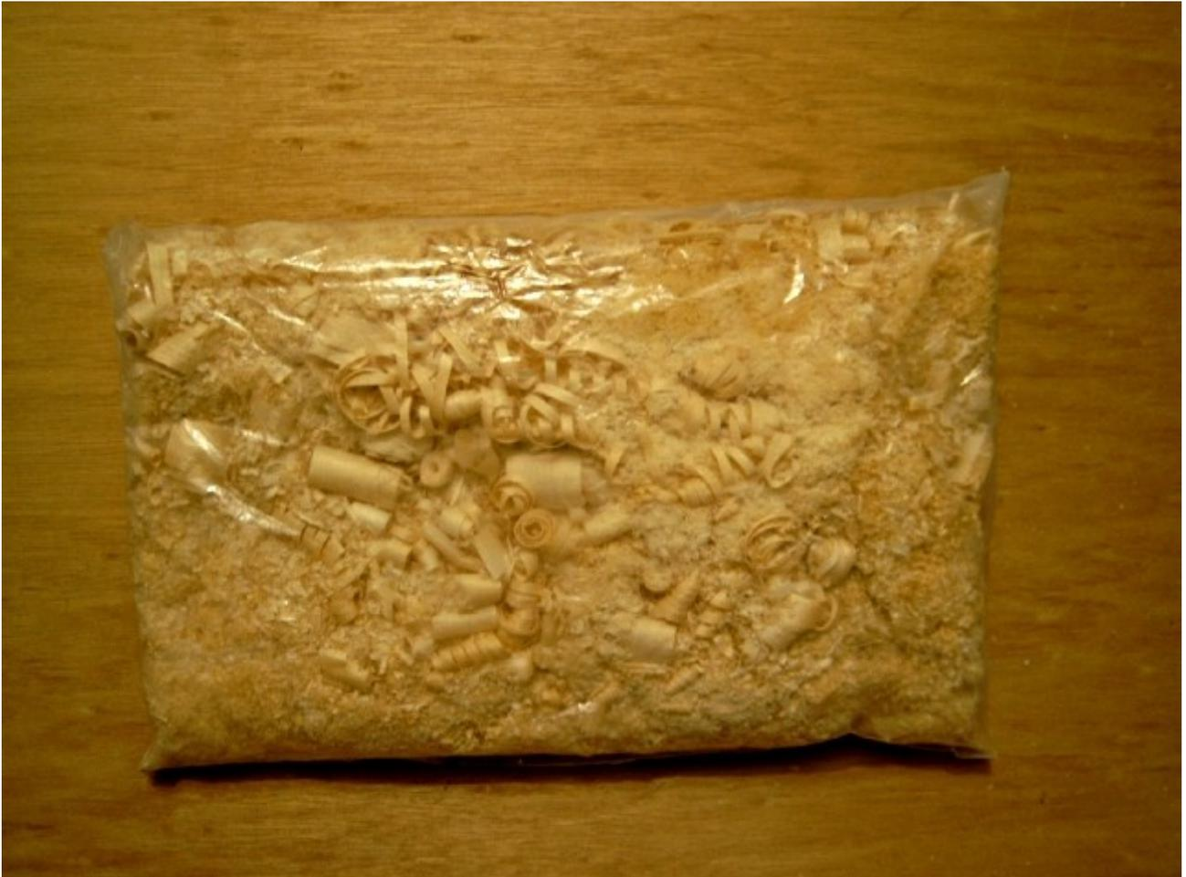
In Längsrichtung lässt sie sich hobeln, als würde man Brot schneiden. Rechtwinklig zur Maserung zerfleddert das Holz unkontrolliert in Tausend kleine Stückchen.
