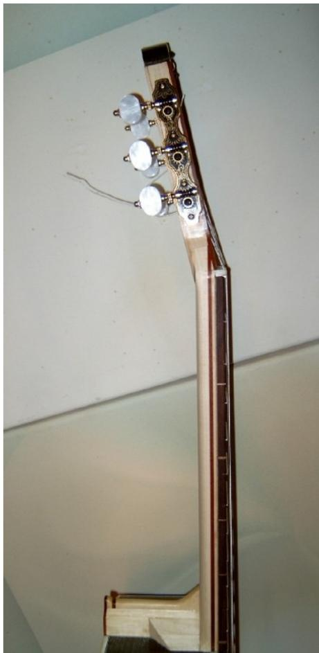
Der Hals besteht aus drei Lagen Holz in der Waagerechten und aus fünf Lagen in der Senkrechten (sperren).
