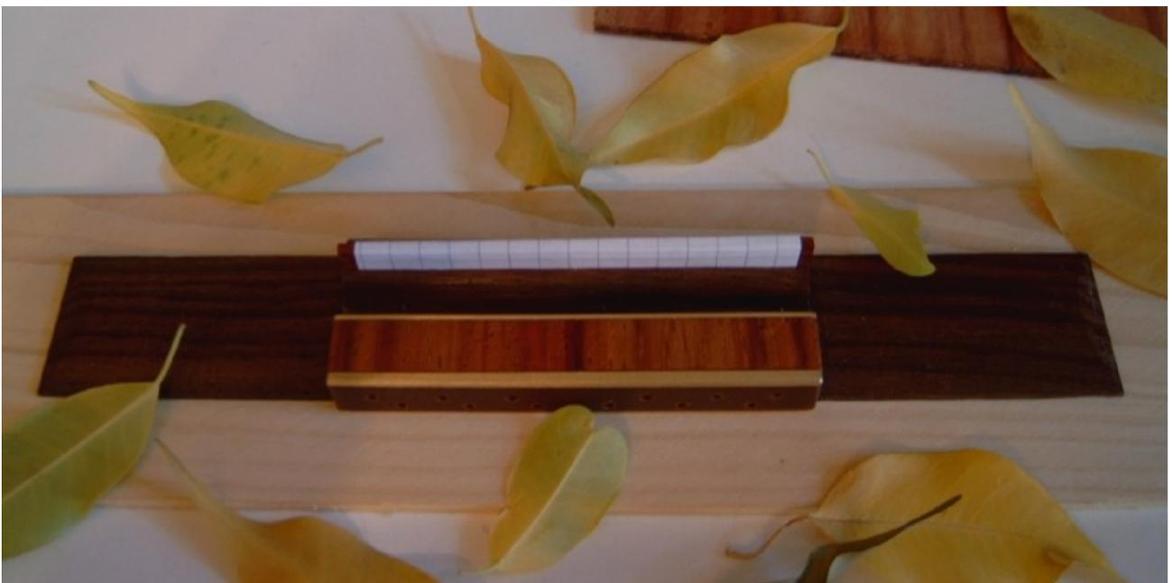
Im Schlitz, der später den Steg aufnehmen wird, steckt das mit Papier umwickelte Holz, das uns aus dem ersten Bild bekannt ist..
