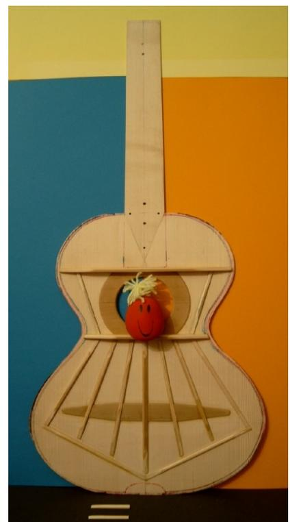
Zur besseren Verdeutlichung der fertigen Unterkonstruktion der Decke. Die beiden Hölzer die zur Stabilisierung der Decke oberhalb des Oberbugs dienen [die Friemel im vorigen Bild als Leiter benutzt hat] sind unten neben Friemel zu sehen. Die wurden noch nicht verleimt, weil sie möglichst exakt an dem inneren Verlauf der Halskonstruktion anliegen sollen. Die werde ich einleimen, wenn Decke und Hals zusammengebracht sind und endlich Hochzeit gefeiert haben.
