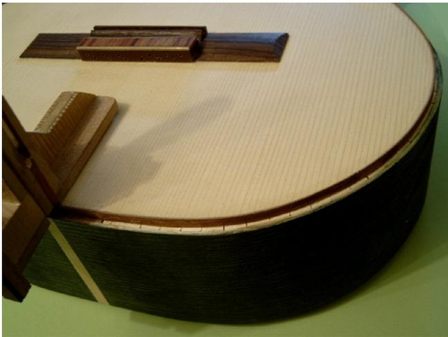
Im Bild links ist links der Randschneider zu sehen, mit dem ich beide Falzen für Decke und Boden sauber ausschneiden konnte.
