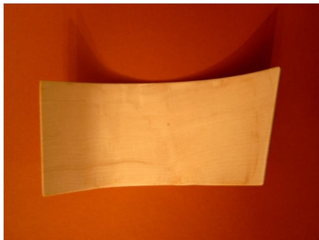
Das Bild zeigt, dass ich das Holz schräg über das heiße Eisen gebogen habe, mit dem Resultat, dass das Holz diagonal zur Längsrichtung gebogen und dem entsprechend verdreht ist.
