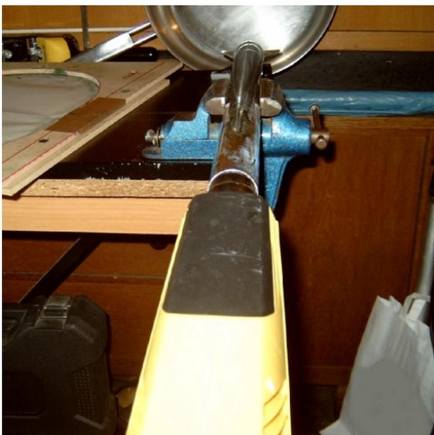
Den heißen Strahl der am Ende des Rohrs austritt, habe ich mit einer Edelstahl-Pfanne aufgefangen, die kann Temperaturen von etwas unter 250° C leicht auffangen ohne Schaden zu nehmen.
