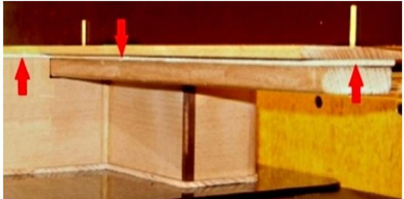
Damals aus einem Stück gefertigt, ist es bei den Maßen für hochwertige Tonhölzer nicht möglich, die Decke bis zum Sattel aus einem Stück zu fertigen. Deshalb habe ich aus Randstücken ein schmales Brettchen in der Halsform zurecht geschnitten, um es als Verlängerung der Decke in diese einzufügen.
