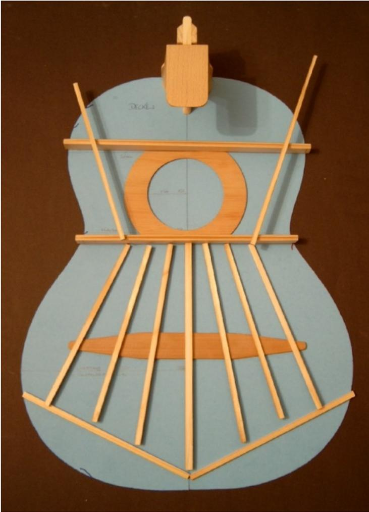
Die exakten Längen und Schrägen der Fächer werden empirisch ermittelt, wenn die Decke aus der Engelmann-Fichte herausgesägt ist und die Zargen einen Kranz bilden.
